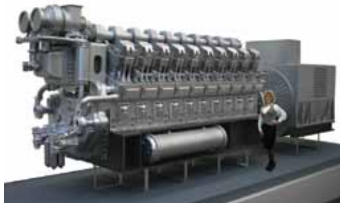
Фото 3. Макет дизель-генератора мощностью 6300 кВт
